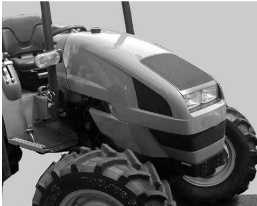
Le capot frontal basculant facilite l'accès pour l'entretien du moteur.
