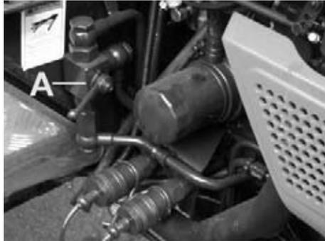
Pour l'actionner, tourner le robinet A qui se trouve sur la droite du tracteur et agir sur la commande du distributeur hydraulique auxiliaire.
