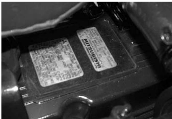
Le numéro de série du moteur est gravé sur la plaque placée sur le moteur.
