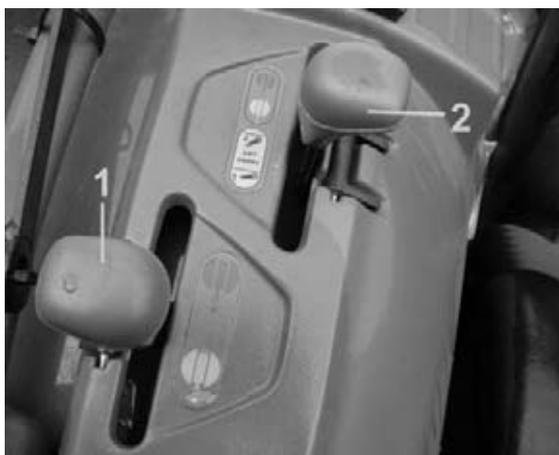
Le déplacement en arrière du levier de pilotage (figure vérin sur fond ROUGE) correspond au refoulement d'huile sous pression à la voie hydraulique supérieure. L'huile en retour du vérin relié à l'outil pourra être mise en décharge à travers la voie hydraulique inférieure.
