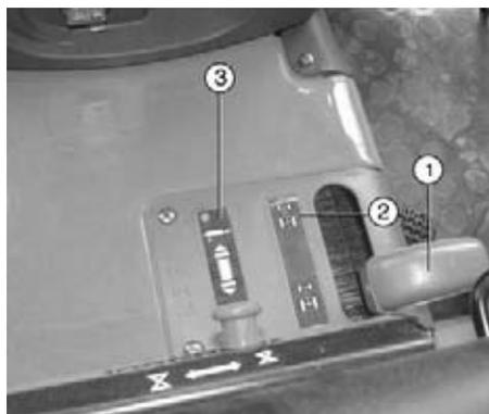
La mise en service du pont avant (son engagement) doit s'effectuer uniquement moteur arrêté en déplaçant en avant le levier 1 comme représenté sur la plaque 2.
