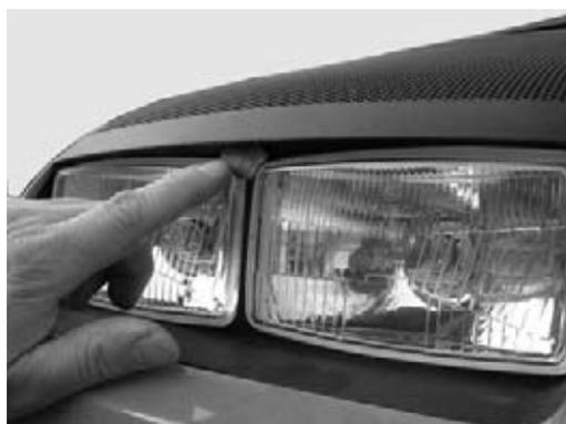
Pour ouvrir le capot, appuyez sur la bouton situé sur la face avant du capot et lever ensuite le capot jusqu'à la verticale.
